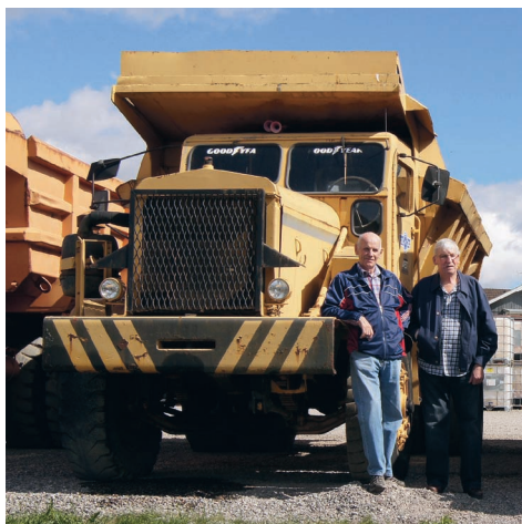
Sven Persson t.v. och Lars Olof Larsson vid en EUCLID R22-truck på Traktormuseet i Indal. EUCLID R22 var den typ av truck som användes på Järkvisslebygget. Här av 1958 års modell, 300 hästkrafter, lastar 20 ton, servostyrning och manuell växellåda. Foto: Arne Johansson.
