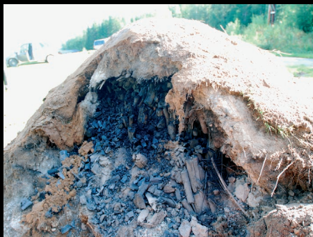
Kolningsprocessen är avslutad och milan öppnas med spänning. Foto: Fredrik Bergqvist.
